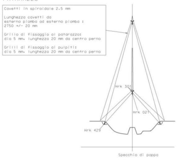
TUTTE LE MISURE RIPORTATE NEL PRESENTE ALLEGATO SONO IN MILLIMETRI. DOVE NON ALTRIMENTI SPECIFICATO HANNO UNA TOLLERANZA DI +/- 5mm
