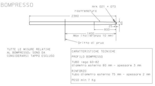
TUTTE LE MISURE RIPORTATE NEL PRESENTE ALLEGATO SONO IN MILLIMETRI. DOVE NON ALTRIMENTI SPECIFICATO HANNO UNA TOLLERANZA DI +/- 5mm
