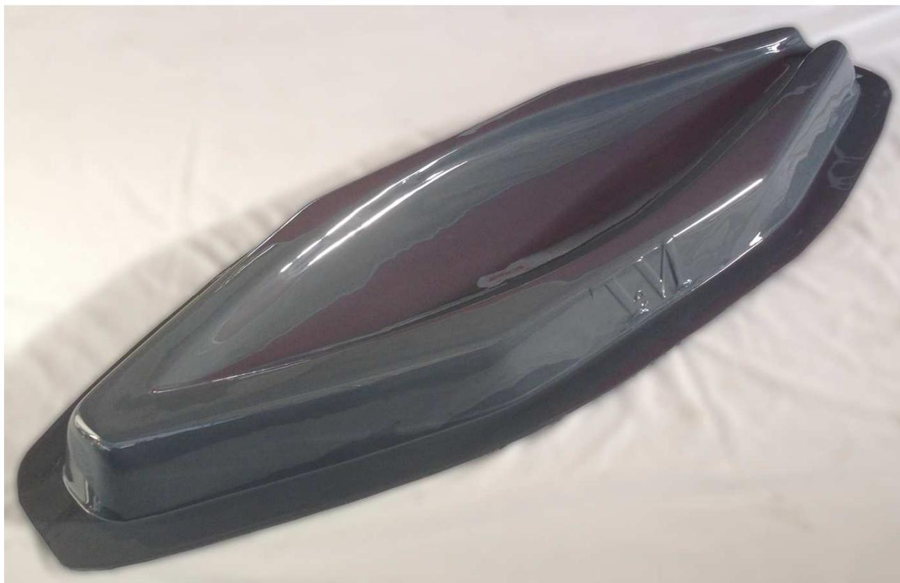
La parte poppiera è stata aperta così da agevolare il posizionamento della barca in fase di alaggio, evitando possibili contatti fra la coda posteriore del bulbo stesso ed il supporto.
