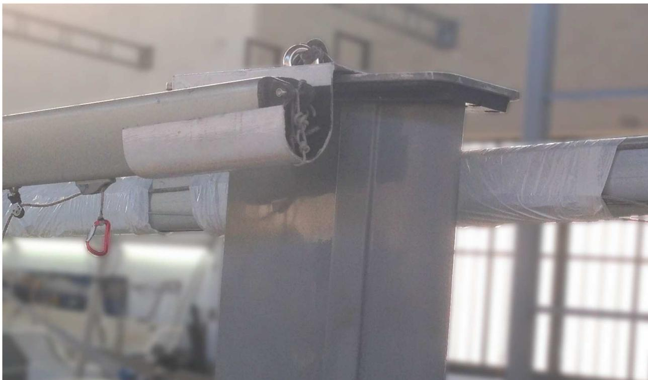
L'utilizzo di questo supporto permette di velocizzare enormemente le operazioni di armo e disarmo e di realizzare al tempo stesso una comoda e sicura posizione di viaggio per il boma.
